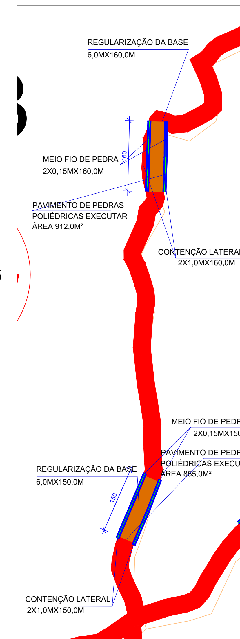
PLANTA PAVIMENTAÇÃO TRECHO 212 ESC. 1:500
